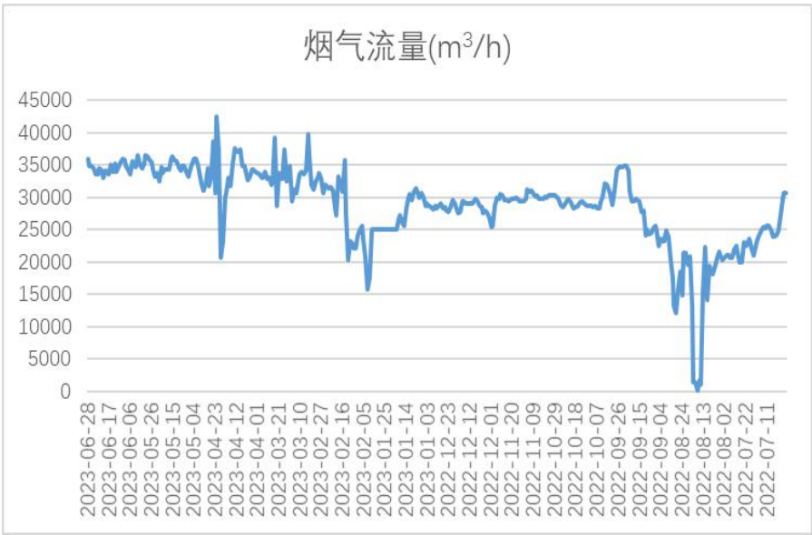
图 7.2-1 昌海生物 RTO 焚烧炉运行负荷曲线图
